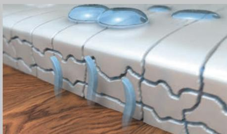
**Рис. 3.2** Аморфная форма полимерных частиц ограничивает скопление воды в лаковой пленке. Несмотря на это, покрытие проницаемо для пара.
